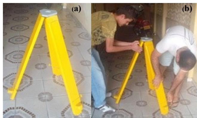
Figura 1 – Montagem do Tripé para sustentação do Teodolito
