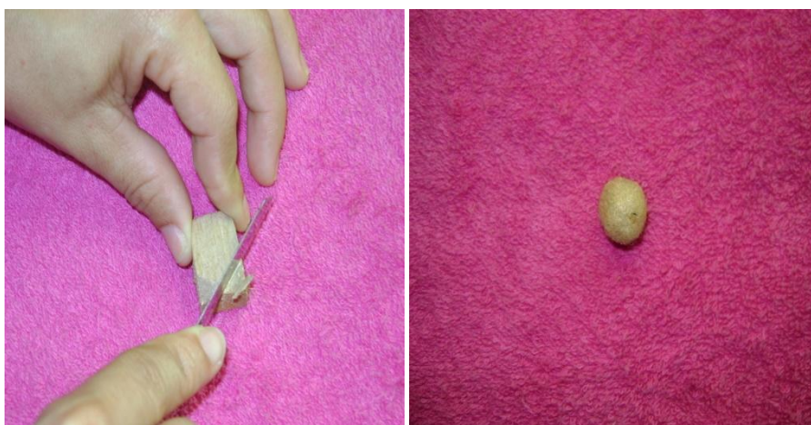
Figura 3: Modelagem da fibra de buriti para adquirir aspecto esférico.
