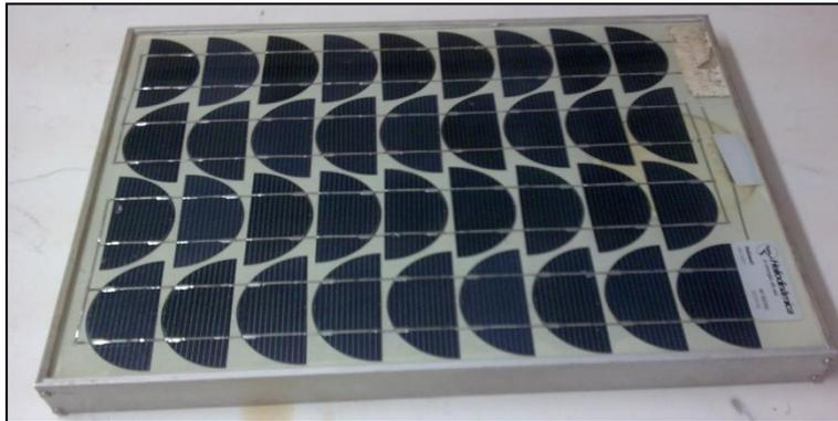
**Figura 12 - Módulo de Silício Monocristalino**
