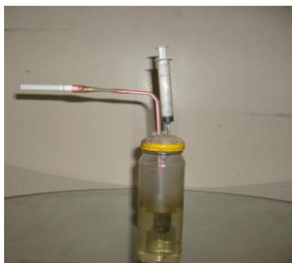
**Figura 2 - Fumômetro Alternativo.**
