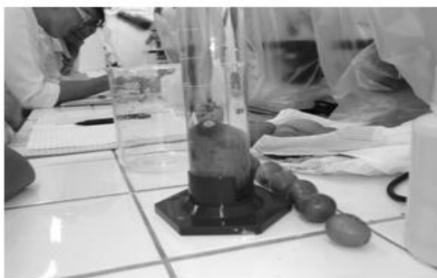
Figura 1 – Determinação da densidade por deslocamento da coluna d’água, em proveta
